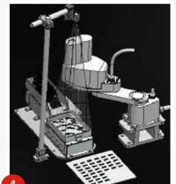
4 機械人基於視覺系統發送的座標數據，從供料器料盤表面抓取零件進行陣列擺盤或組裝。
