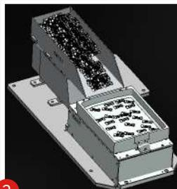
2 柔性供料器可將零件在料盤表面沿任意方向移動，快速振散、集中、排列零件。
